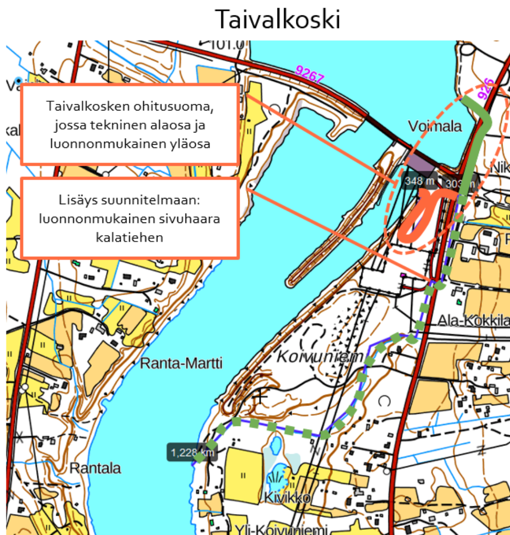
Kuva 6 Taivalkosken suunniteltu ohitusuoma yhtenäisellä viivalla ja sitä täydentävä luonnonmukainen jatko-osa katkoviivalla. Vihreä osuus on luonnonmukaista.
